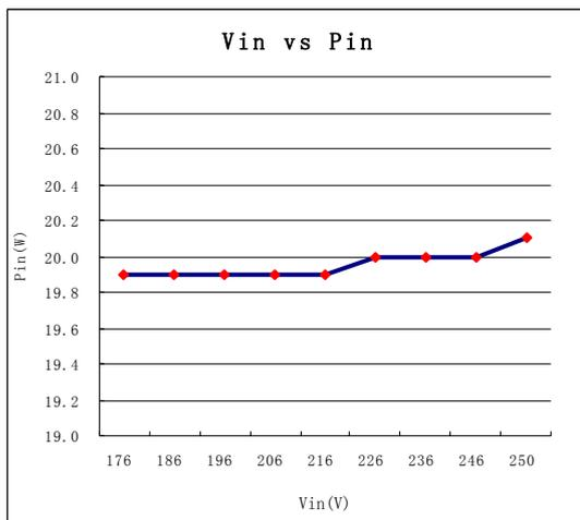
b) 输入电压对输出功率曲线图
